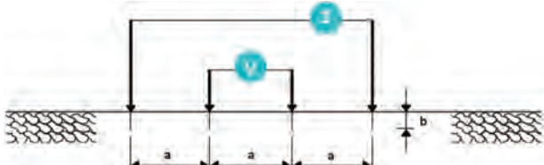
Figura 3.12.4.1. a. Esquema de medición de resistividad aparente. Fuente: Adaptada de la Resolución 90708 del 2013.
