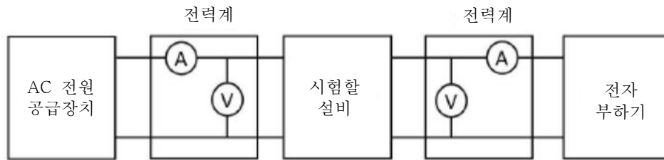
그림 D.1 매립형 전원공급장치의 동작 효율 및 역률값 시험 연결도(단일 입력, 단일 출력)
