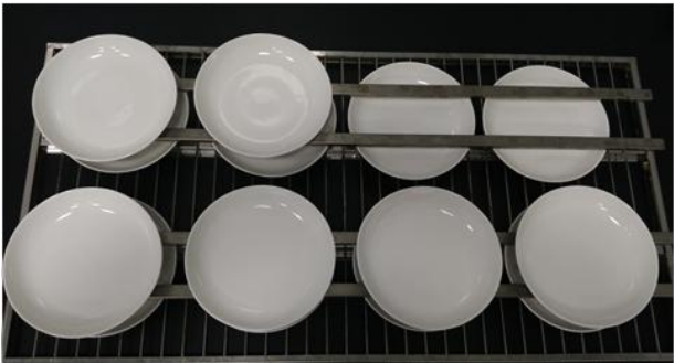
图 E. 8 第 7 层深盘的装载图
