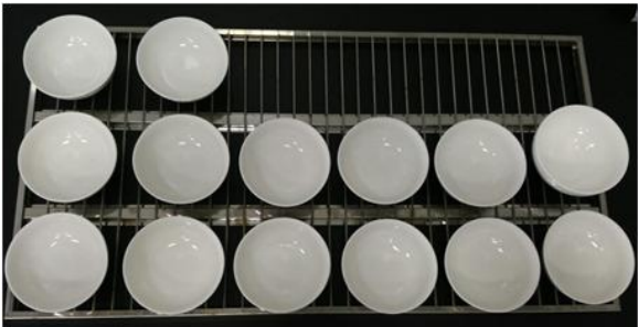
图 E. 5 第 4 层面碗的装载图
