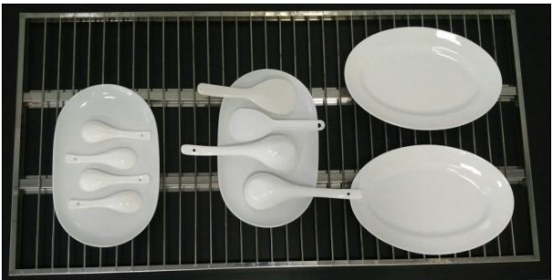
图 E. 6 第 5 层蒸鱼盘、饭勺、汤勺、小汤勺的装载图
