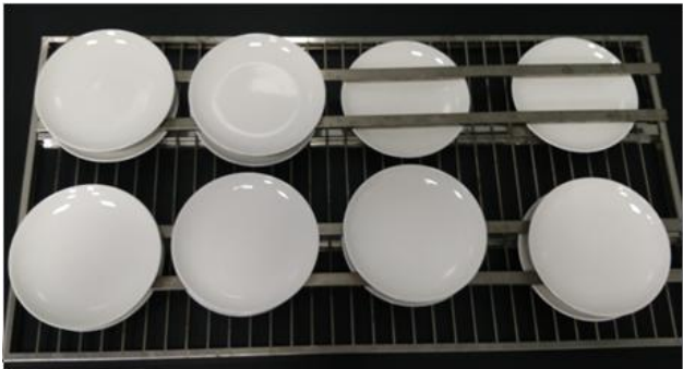
图 E. 9 第 8 层浅盘的装载图
