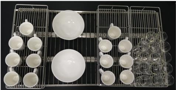
图 E. 7 第 6 层玻璃杯、马克杯、大汤碗的装载图
