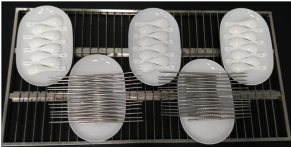
图 E. 2 第 1 层筷子、小汤勺的装载图
