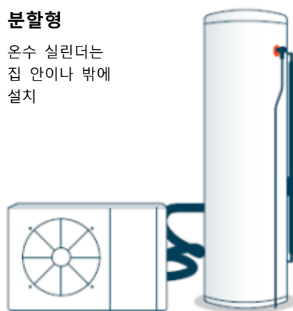
그림 2: 일반적인 내장형(일명 '통합형') 시스템과 분할형 시스템의 도해
