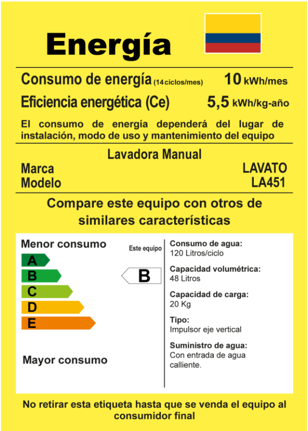
Figura 7.7.6.c Ejemplo de etiqueta para Lavadoras de Ropa manuales
